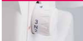
La manopola si trova sul lato destro della macchina con una scelta da 1 a 4 mm.
